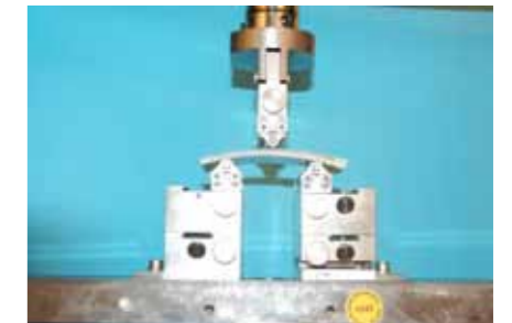
De sterkte van de liner wordt getest door de driepuntsbuigproef.
