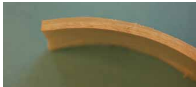
De liner is opgebouwd uit verschillende dragerlagen met hars.
