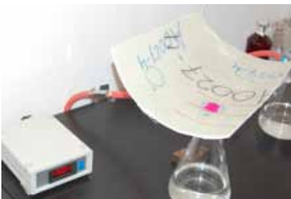
De liner wordt getest op waterdichtheid.
