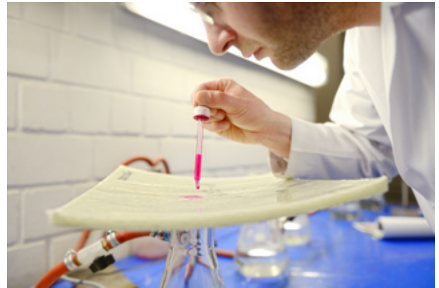
Waterdichtheidstest van een CIPP-proefstuk in het IKT-laboratorium
