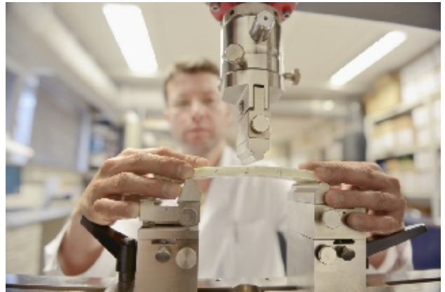
Driepuntsbuigproef voor CIPP-Liners
