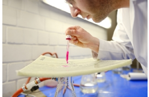
Waterdichtheidstest op CIPP-liners
